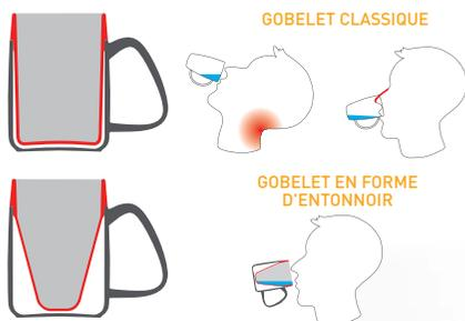
Le même gobelet existe avec une forme d'entonnoir à l'intérieur, ce qui lui donne la même fonction qu'un gobelet avec une découpe nasale. Il ne faut plus pencher la tête en arrière pour boire convenablement.
